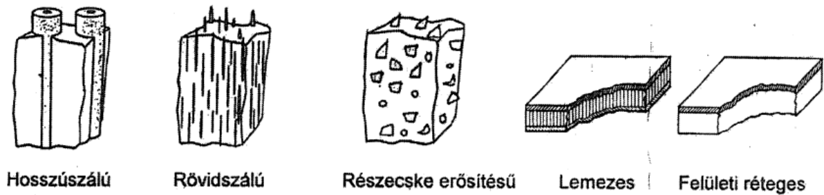
8. ábra. A kompozitok felépítése
